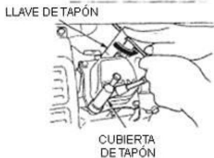
4) Inspeccione visualmente la bujía. Deséchelo si el aislador está agrietado o astillado. Limpie la bujía con un cepillo de alambre si se va a reutilizar.
